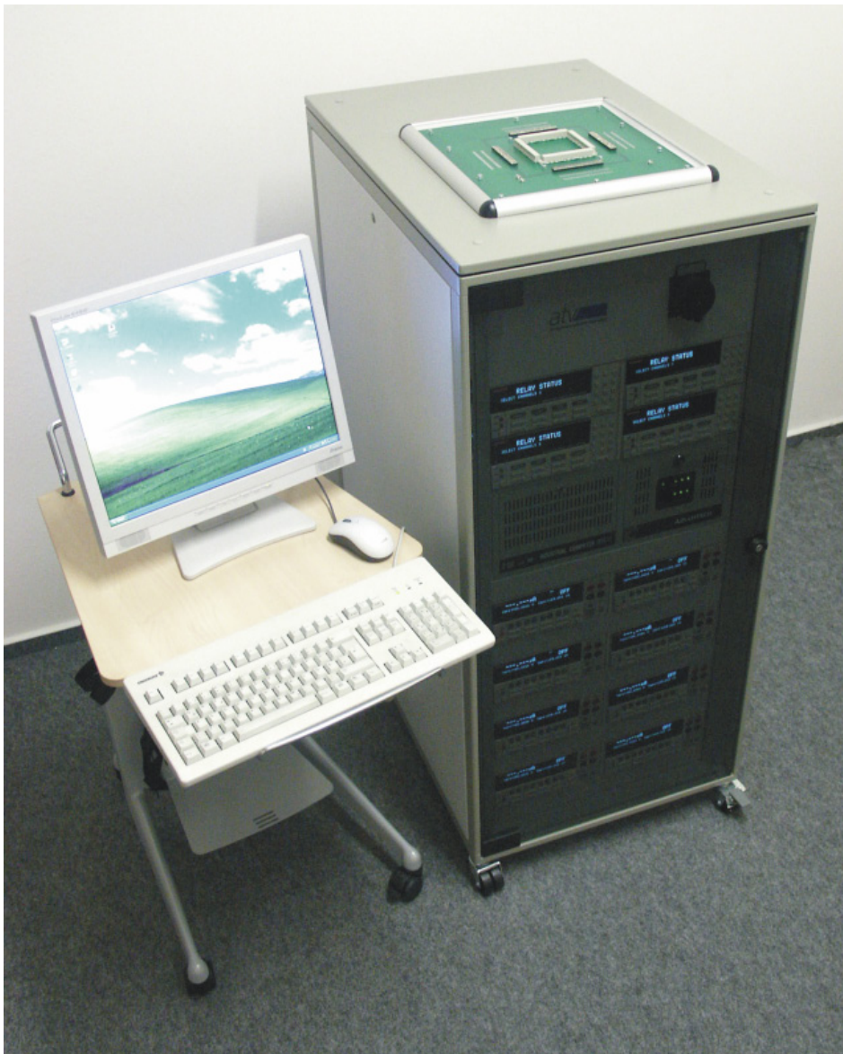
PinTester Testsystem für 128/256 Pins
